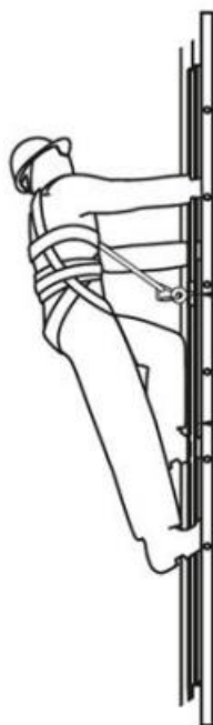
Exemplo de sistema baseado em linha de ancoragem vertical rígida instalada de forma permanente. Fonte: NBR 16489
