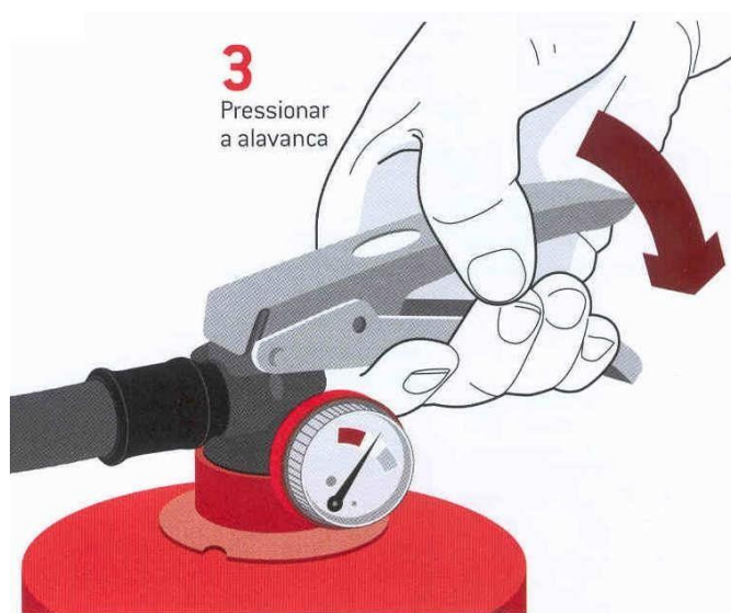
Figura 22 - Uso da alavanca para liberar o agente extintor Fonte: FDE
