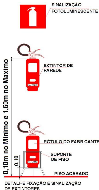
Figura 24 - Fixação de extintor. Fonte: DSCI
