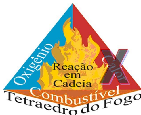
Figura 19 - Retirada do calor - Fonte: 9ºGB – CBPMESP
