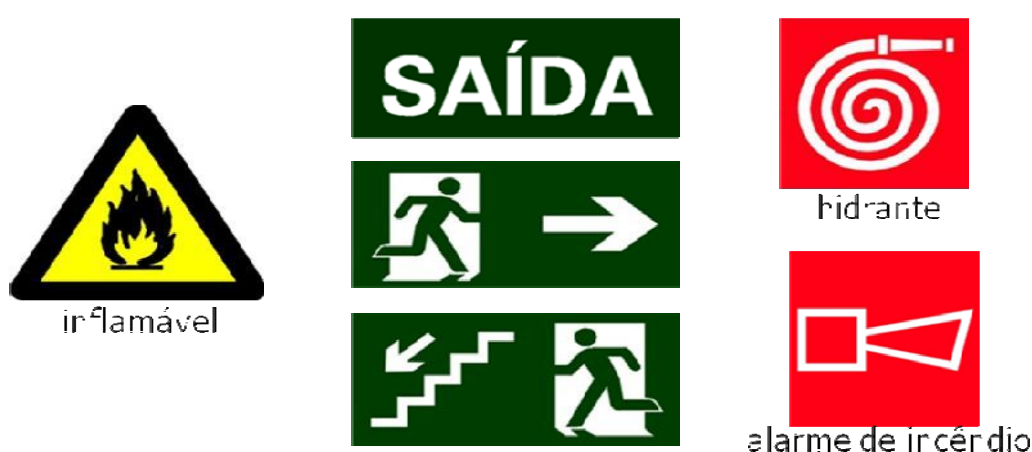
Figura 5 - Sinalização de segurança. Norma: IT-20 do CBPMESP
